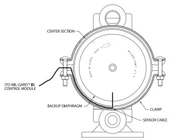
Figure 1 SIDE VIEW OF PUMP
